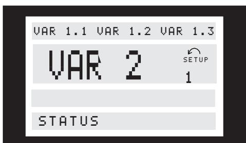
O lado esquerdo da linha de status indica o elemento de controle do conversor de freqüências que está ativo. AUTO significa que o controle é feito através dos terminais de controle, ao passo que HAND indica que o controle é feito por meio das teclas locais da unidade de controle.
