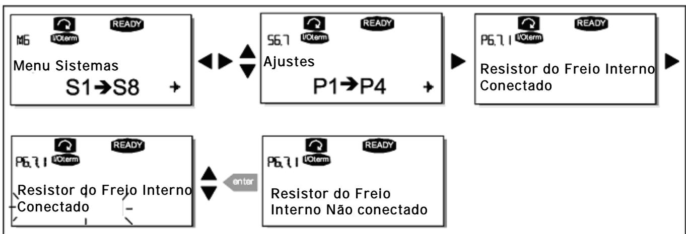
Figura 7-21. Conexão do resistor do freio interno
