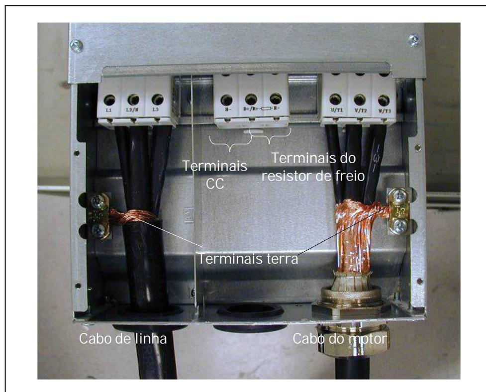
Figura 6-15. Instalação dos cabos no Vacon NXS/P, FR7
