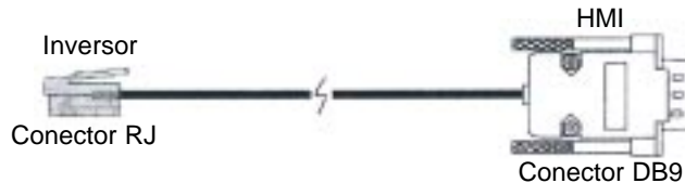
Figura 8.10 - Cabo CAB-HMI08-S para HMI-CFW08-S
